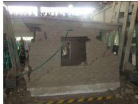
شکل ۶- مدل تقویت نشده بعد از آزمایش شکل آزمایش
