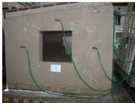
شکل ۸- رفتار لرزه ای مدل تا فاز ۲
