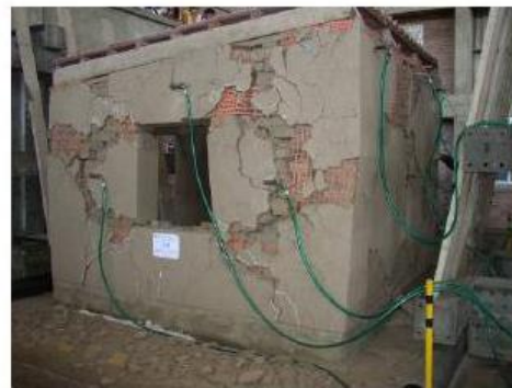
شکل ۹- رفتار لرزه ای مدل تا فاز ۳
