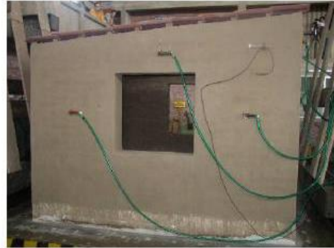
شکل ۴- نصب تجهیزات اندازه گیری روی مدل
